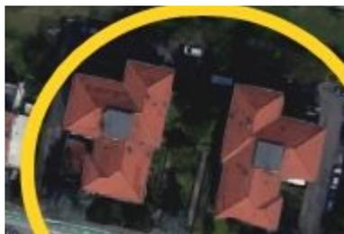
Entrambi gli edifici sono caratterizzati da struttura portante a telaio in cemento armato e tamponamenti in muratura, con copertura a tetto a più falde.
